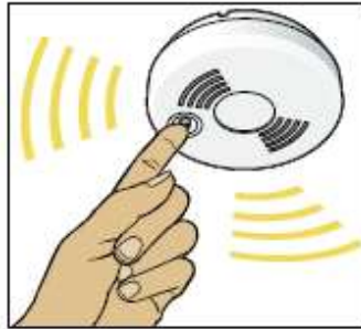
Testa brandvarnaren varje månad. Tryck på testknappen.
