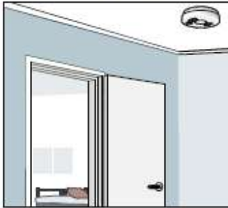
Brandvarnaren ska sitta i taket.
